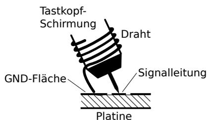
Abbildung A.1.: Tastkopf ohne Massekabel
